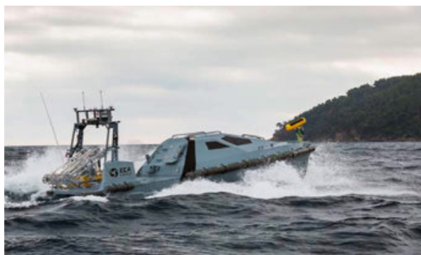
L'ensemble Inspector Mk2, sonar Towsca et Rov Seascan constitue un système de lutte anti-mines côtier.
